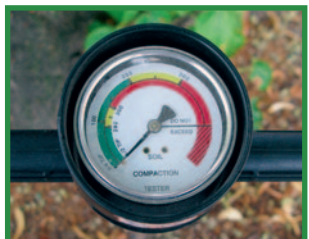
Een bodemdichtheid van 1,5 MPa is nefast voor de groei van een boom
